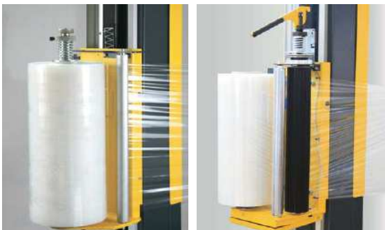
EM Frein mécanique sur l'axe de la bobine
