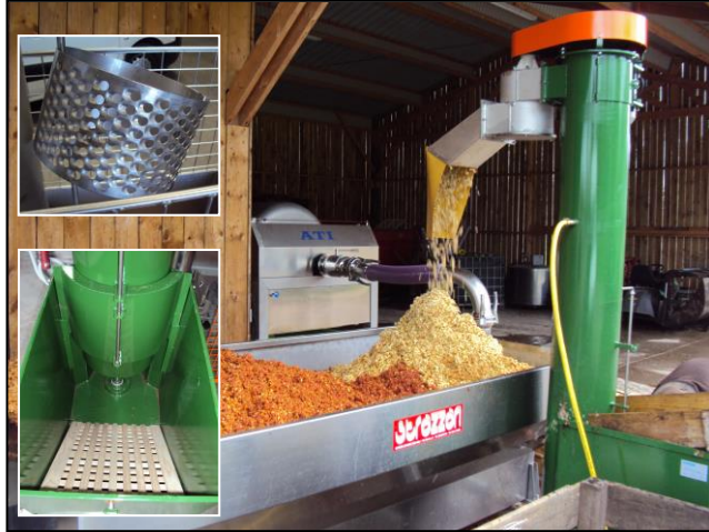
Intérieur bac de lavage
